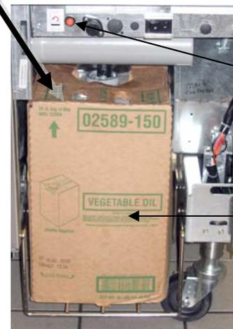
**F: Pulsante di reset del filtro dell'olio:** Premere e tenere dopo aver sostituito il fusto dell'olio fino a che la luce gialla non si spegne.
