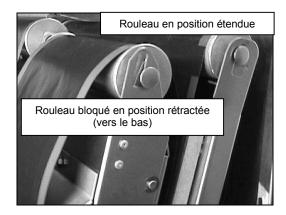
5. Faites pivoter le dispositif antibasculement vers le haut pour désenclencher.
