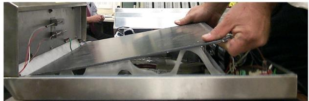
Levante suavemente la placa, que puede estar aún pegada al adhesivo. Aplique cinta acrílica nueva al chasis antes de volver a instalar la placa.
