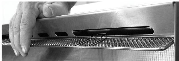
La pantalla del filtro encaja en la parte posterior de la torre de entrada del aire.
