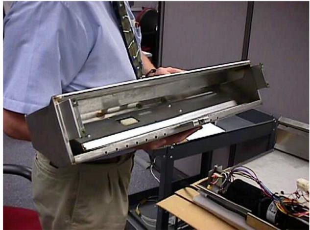
La cubierta está fijada mediante cinco tornillos, que se retiran de la parte inferior de la unidad.
