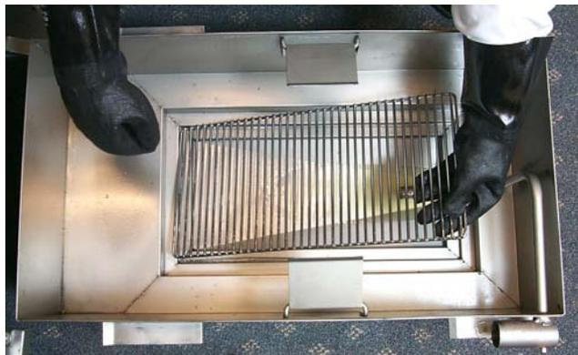
Colocación de la malla del filtro (rejilla de la fuente) en la fuente del filtro.
