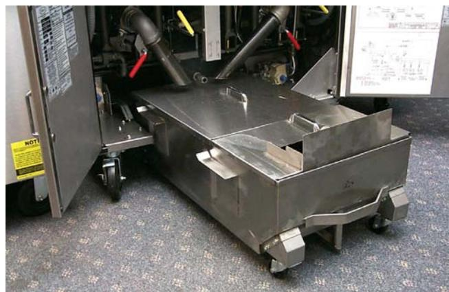
*Filtro típico bajo la freidora (UFF) instalado en un sistema para freír con varias baterías.*
