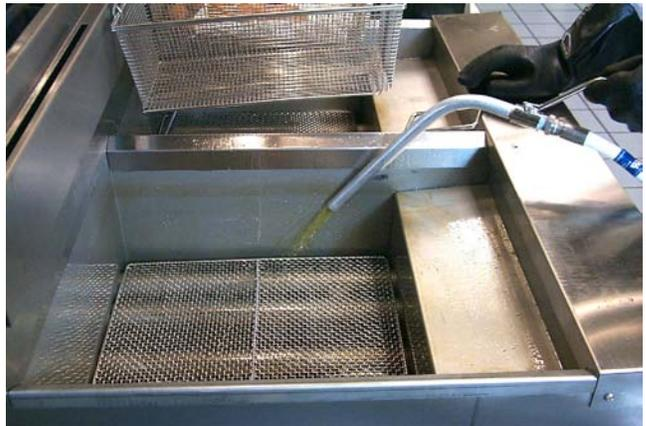
Use la varilla para lavar residuos de la olla hacia la fuente de filtro. Mantenga un agarre firme en la empuñadura de la varilla en todo momento.
