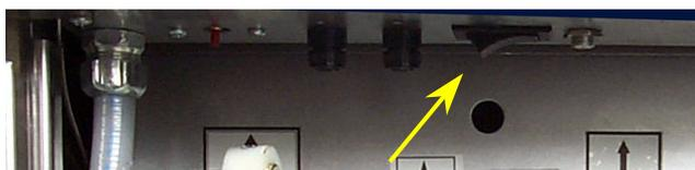
Después de que el extremo de la manguera/varilla esté debidamente colocado en la olla, active la bomba del filtro con el interruptor auxiliar dentro del gabinete (flecha).
