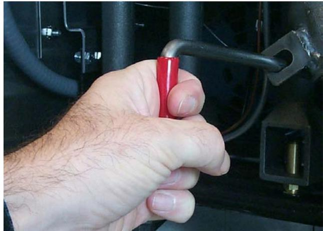
Tire del mango rojo para abrir la válvula de drenaje.
