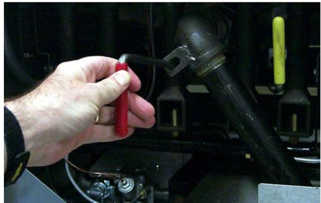
Después de terminar la filtración, cierre el mango rojo de drenaje para comenzar a llenar otra vez la olla.
