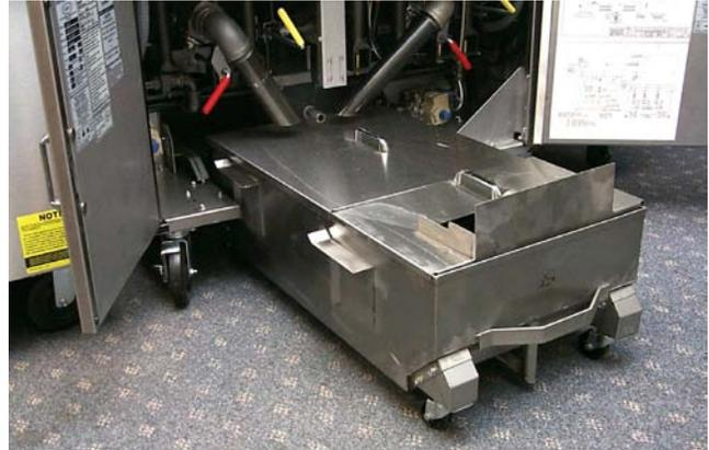
La fuente del filtro se desliza bajo la freidora (arriba), conectando con un accesorio deslizante (derecha). La ubicación del accesorio deslizante varía (arriba o al costado de la fuente), según el sistema para freír.
