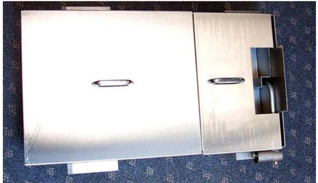
Cubiertas colocadas correctamente sobre la fuente de filtro.
