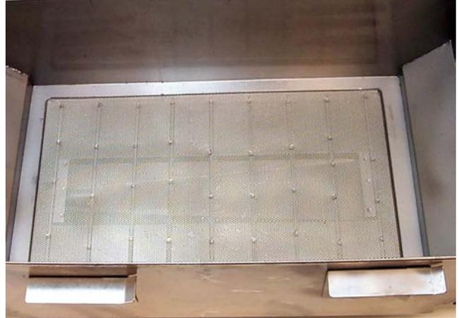
Rejilla de soporte colocada correctamente en la fuente del filtro.
