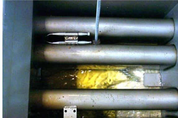
Limpie todo el sedimento y las partículas suspendidas de los tubos del quemador y de la olla al comenzar a circular el aceite. Tenga cuidado de no perturbar las sondas (flecha) del tubo del quemador.
