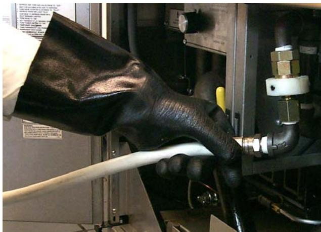
Tiro del mango rojo para abrir la válvula de drenaje, permitiendo que drene el aceite caliente dentro de la fuente de filtro.
