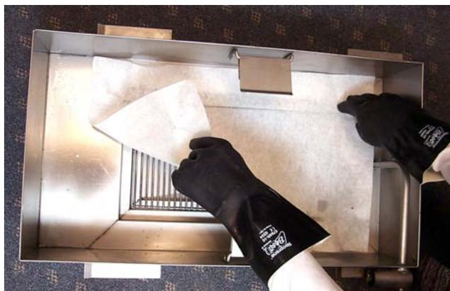
3. Instale el aro de sujeción sobre el papel de filtro. Revise que el aro de sujeción esté asentado correctamente en el hueco del fondo.
