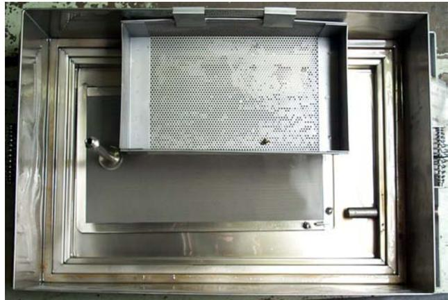
Tubo de toma colocado correctamente en el agujero de acceso de la tapa de la fuente.
