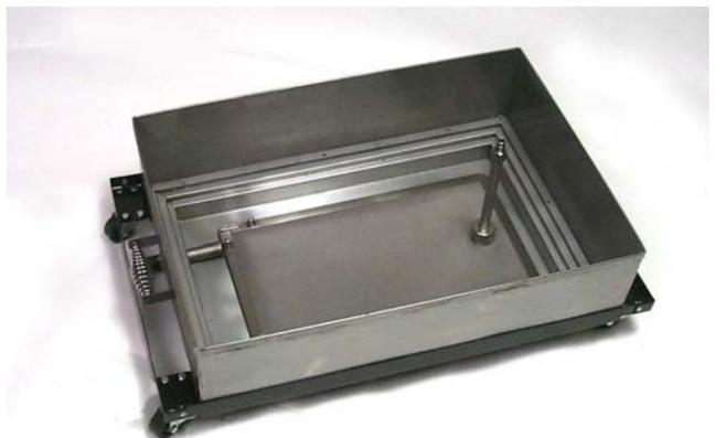
Hoja de filtro colocada correctamente en la fuente del filtro.
