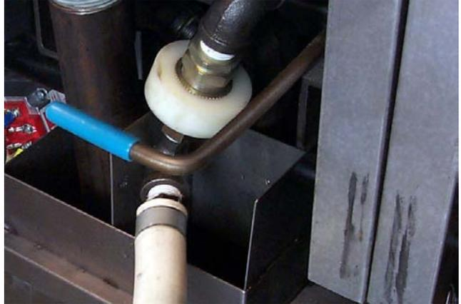
Al tirar del mango azul se abre la válvula de lavado en las freidoras equipadas así.
