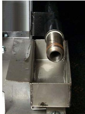
Installation correcte de la cuvette ramasse-gouttes.
