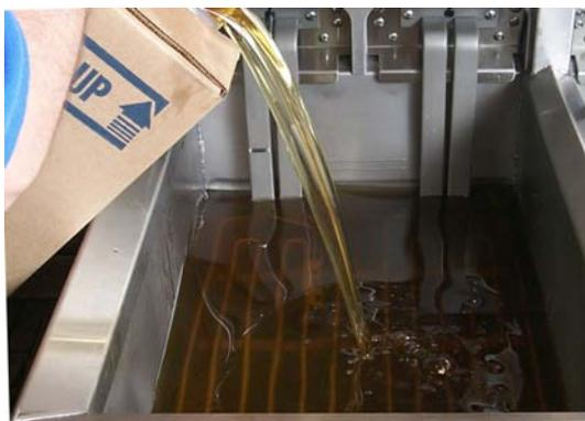
Ajoutez de la graisse/l'huile jusqu'à ce que le niveau atteigne le repère OIL LEVEL supérieur. **NE REMPLISSEZ PAS TROP LA CUVE.**
