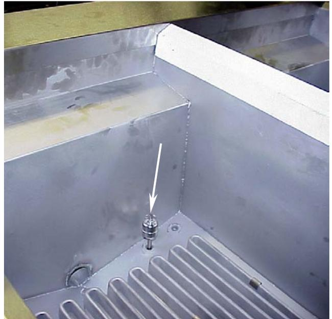
Emplacement de l'interrupteur de sécurité à flotteur.
