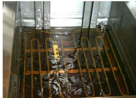
Remplissage de la cuve avec graisse/huile filtrée.
