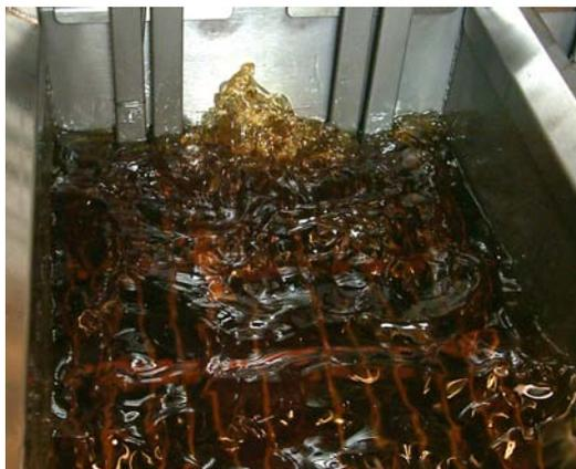
Laissez la graisse/l'huile faire des bulles pendant 10 à 15 secondes pour garantir l'évacuation complète de la graisse/l'huile des conduites de retour.
