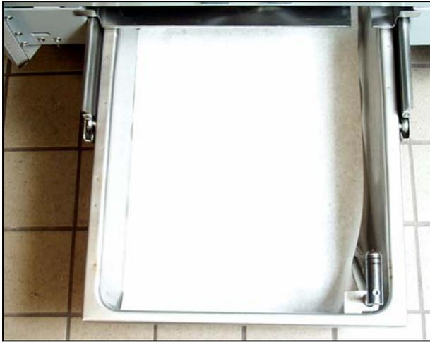
Einen Bogen Filterpapier oder einen Filtereinsatz über das Sieb legen. Wenn der EINSATZ verwendet wird, sicherstellen, dass die rauhe Seite nach oben zeigt.
