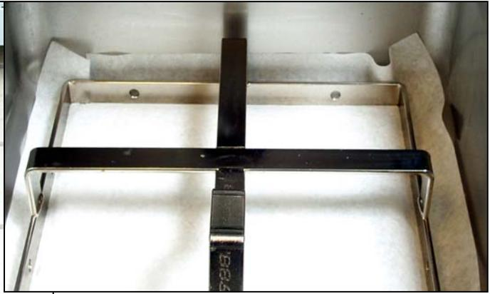
Wenn Filterpapier verwendet wird, den Niederhaltering über dem Filterpapier aufsetzen und den Ring in die Wanne absenken, damit das Papier um den Ring aufgefalt wird, wenn dieser auf den Boden der Wanne gedrückt wird.
