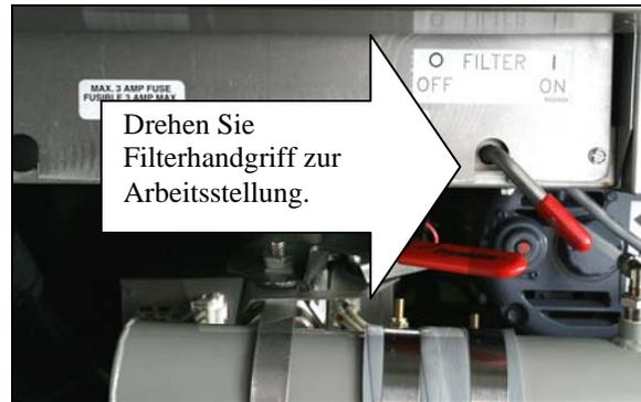
5. Die Filterpumpe zieht das Fritierfett/Öl durch den Filter und pumpt es in einem 5 Minuten langen Vorgang, der als Klären bezeichnet wird, zurück durch die Fritierwanne. Beim Klären wird das Fett/Öl gereinigt, indem Feststoffteilchen im Filter gefangen werden.
