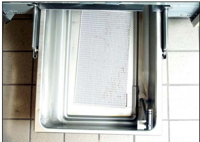
**Das Filtersieb auf den Boden der Filterwanne legen.**
