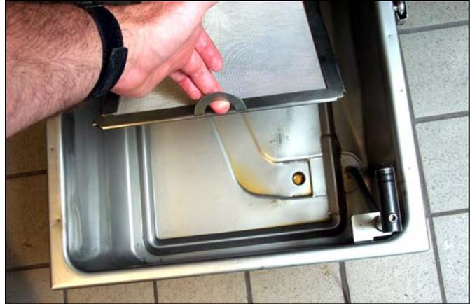
Das Krümelblech und das Filtersieb aus der Wanne entnehmen. Alle Komponenten mit einer Lösung aus Waschmittel und heißem Wasser reinigen und dann gründlich trocknen.
