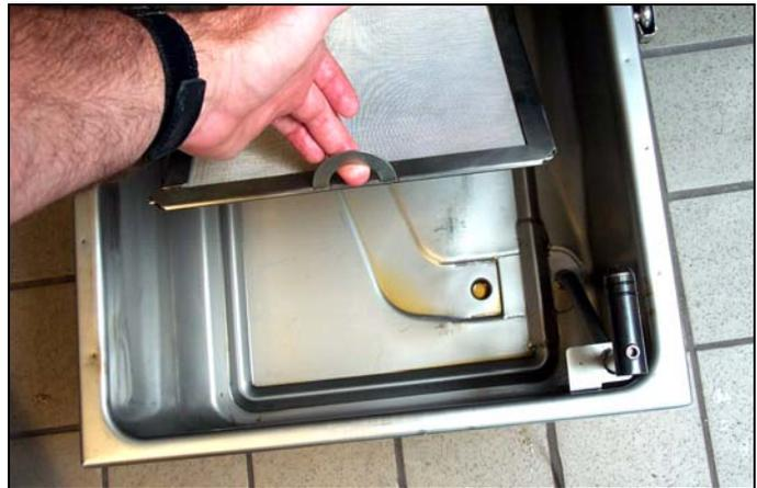
Die Filterbaugruppe in die Filterwanne einsetzen. Dabei darauf achten, dass die Verschraubung unten an der Baugruppe sicher im Anschluss unten in der Wanne sitzt. Einen Becher Magnasol XL Filterpulver gleichmäßig auf das Sieb leeren.
