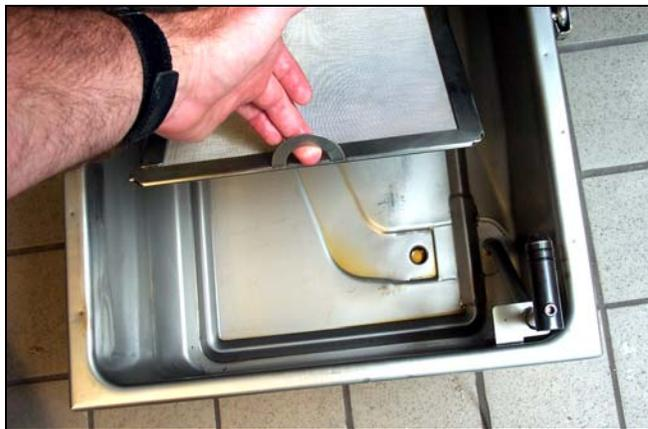
**Retire la bandeja de migas y la malla de filtro de la fuente. Limpie todos los componentes con una solución de detergente y agua caliente, luego séquelos totalmente.**
