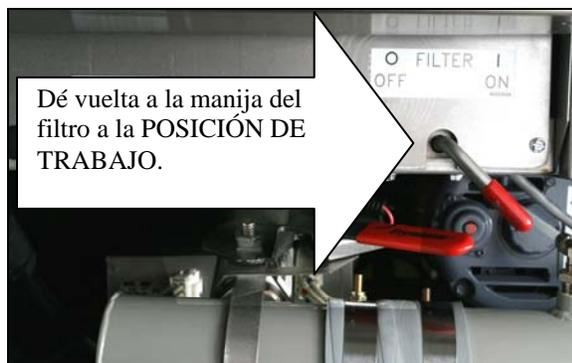
5. La bomba de filtro hace pasar el aceite o la manteca a través del medio filtrante, circulando por la olla durante un proceso de depuración que dura 5 minutos. La depuración limpia el aceite atrapando las partículas sólidas en el medio filtrante.
