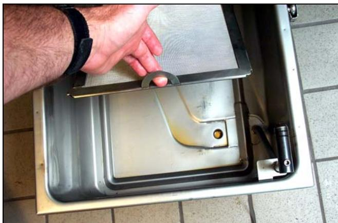
**Retirez le plateau ramasse-miettes et le filtre métallique du bac. Nettoyez tous les composants avec une solution de détergent et d'eau chaude, puis essuyez bien.**
