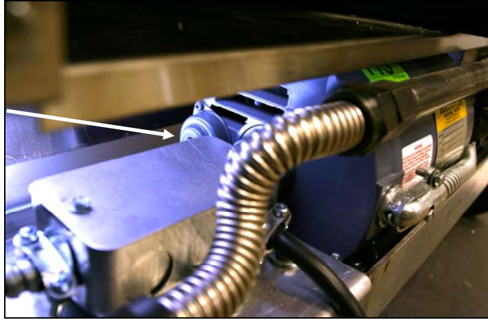
Filtre Pompası Sıfırlama Düğmesi (Ok)
