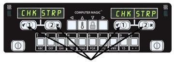
Une pression sur l'un ou l'autre des boutons de cycle de cuisson sous <code>CHK 5TRP</code> lance un cycle de cuisson.
