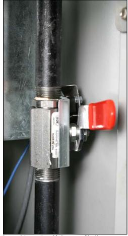
Le robinet de décharge d'huile est en position Fermé. Appuyez pour décharger l'huile du bac du filtre.
