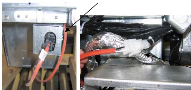
**Figura 3:** Collegare i connettori bianchi a due pin e collegare il connettore nero nella casella di utilità come mostrato..
