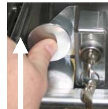
**Bulk Oil System (Sistema ad olio sfuso):** Il computer visualizza **INSERT PAN** (inserire bacinella) . Riposizionare il tampone.
