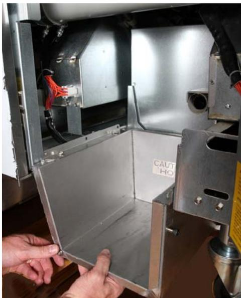
**Figura 2:** Posizionare l'unità di fusione.
