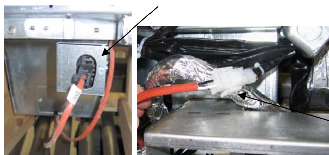
Фигура 3: Прикрепете двуполусни бял конектори и се включете черния конектор в полето на полезността, както е показано.
