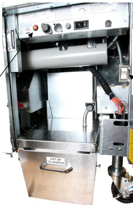
Фигура 3: Прикрепете двуполусни бял конектори и се включете черния конектор в полето на полезността, както е показано.
