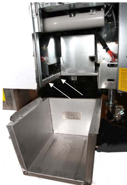
Фигура 1: Позиция на топене на единица в кабинета и се прикрепва с винтове, за да вътрешността на шкафа.
