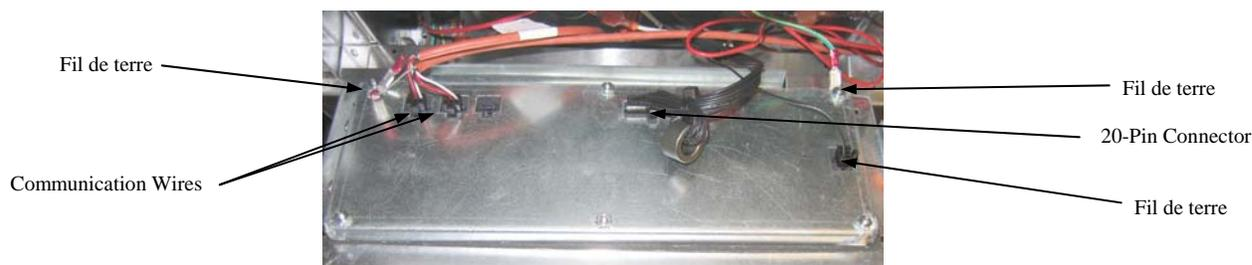
5. Installez l'ordinateur de remplacement. Réinstallez l'assemblage du panneau de commande en revenant en arrière depuis les étapes de 1 à 4.
