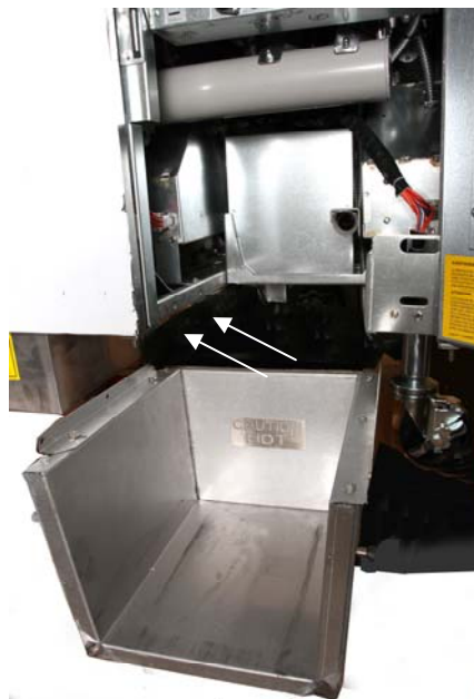
Εικόνα 1: Τοποθετήστε το melter στο ερμάριο και προσαρτήστε το με τις παρεχόμενες βίδες στο εσωτερικό του ερμαρίου.
