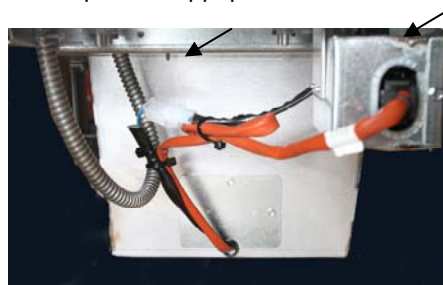
Εικόνα 3: Προσαρτήστε τους λευκούς συνδέσμους δύο πείρων και συνδέστε το μαύρο σύνδεσμο στο κιβώτιο συνδέσεων, όπως στην εικόνα.
