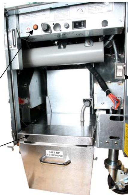
**Figure 4 :** Le bac de fusion monté présenté en position.
