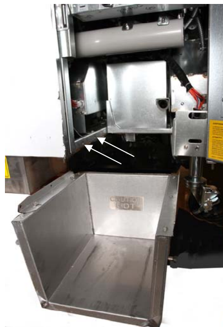
Abbildung 1: Das Schmelzgerät im Gehäuse anbringen und mit den mitgelieferten Schrauben an der Innenseite des Gehäuses befestigen.
