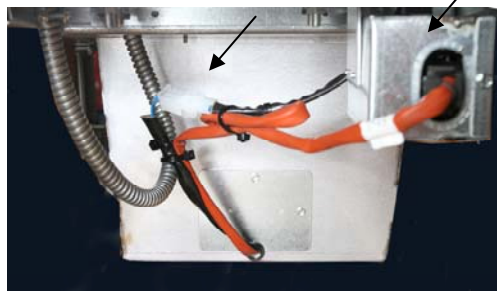
Abbildung 3: Den weißen 2-poligen Stecker befestigen und den schwarzen Stecker an die Netzdose anschließen.
