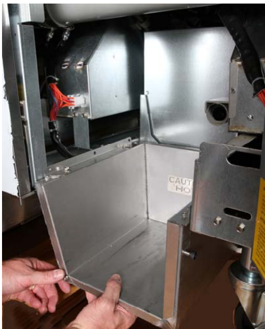
Abbildung 2: Das Schmelzgerät platzieren.
