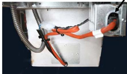
**Figura 3:** Collegare il connettore nero nella scatola come mostrato. Un cablaggio separato con una presa bianca, se presente, **NON** è utilizzato.
