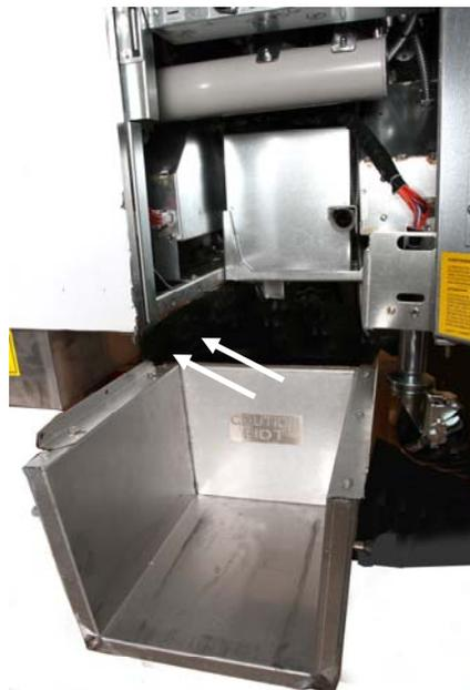
**Figura 1:** Posizionare lo scioglitore nell'armadietto e fissare con le viti fornite all'interno dell'armadietto.
