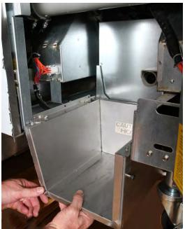
Рис. 2. Установите устройство для растапливания.
