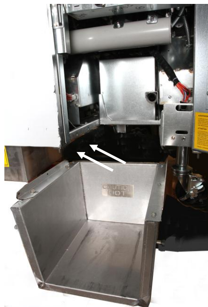
Obrázek 1: Umístěte rozpouštěč do skříně a připojte jej dodanými šrouby do jejího vnitřku.
