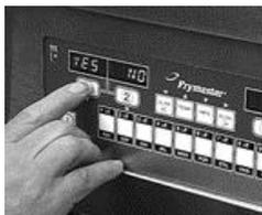
**Mit Fett gefülltes Becken:** Die Taste 2 ✗ drücken. Auf der Steuerung wird ENTSORGUNG LAEUFT angezeigt, gefolgt von abwechselnd BECKEN LEER? und JA?
