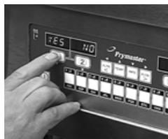
**Mit Fett gefülltes Becken:** Press the 2 ✕ key. Auf der Steuerung wird abwechselnd SDU AN DER RICHTIGEN STELLE und JA NEIN angezeigt.
