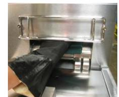
Nachdem eine Fläche gereinigt wurde, Rückstände mit einem in Hygienelösung angefeuchteten Tuch abwischen. **Sicherstellen, dass in der Umgebung von heißem Fett keine Lösung vom Tuch tropft.**
