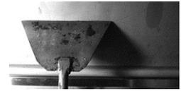
Bei einer elektrischen Friteuse als nächstes mit dem Kittmesser alles weiche Fett und alle harten Verkohlungen von den Blechen rund um die Friteuse, dem Abstandhalter und dem Friteusengestell entfernen. Wenn diese Bereiche gereinigt sind, mit Schritt 8 weitermachen.
