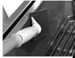
Die Seiten, Vorder- und Rückwand und Oberseite des Beckens mit Hi-Temp Pad-Halter, Pad und Friteusenreiniger reinigen. Alle Rückstände entfernen. Mit der Hi-Temp Detailbürste zwischen und unter den Spulen, in den Beckenecken und an allen anderen schwer erreichbaren Stellen reinigen.
