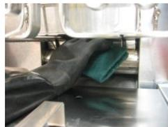
Nachdem die Fläche gereinigt wurde, Rückstände mit einem in Hygienelösung angefeuchteten Tuch abwischen. **Sicherstellen, dass in der Umgebung von heißem Fett keine Lösung vom Tuch tropft.**
