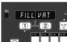
Die Taste 1 ✓ drücken, wenn das Becken bis zur unteren Fettstandslinie gefüllt ist.
