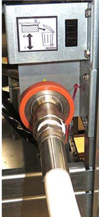
19. Raccorder le tube de mise au rebut en tirant sur le collet du connecteur femelle et en poussant ce dernier fermement sur le raccord à déconnexion rapide mâle. Une fois en place, relâcher le raccord à déconnexion rapide et s'assurer que le raccord est complètement verrouillé. S'assurer que le dispositif de mise au rebut est placé en avant de la friteuse et appuyer sur la touche √ (crochet - OUI) pour continuer.
