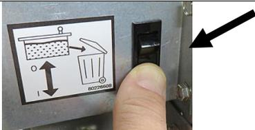
21. S'assurer que le tube est installé avant de tenir enfoncée la touche de mise au rebut pour commencer la vidange.
