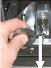
20. Ouvrir la porte d'armoire gauche et déverrouiller le robinet, au besoin. Tirer complètement sur le robinet de mise au rebut afin de lancer la mise au rebut.
