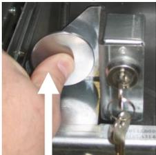
22. L'huile est transvasée du bac du filtre au dispositif de mise au rebut. Lorsque le bac est vide, relâcher l'interrupteur afin d'arrêter la pompe. Une fois le dispositif rempli, fermer le robinet de mise au rebut en poussant complètement la poignée du robinet dans la friteuse jusqu'à ce qu'elle s'arrête. Au besoin, le gestionnaire doit verrouiller le robinet à nouveau. Passer à l'étape 27.
