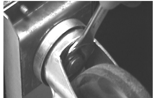
Apriete la ruedecilla con una llave inglesa de extremo abierto de 18mm
