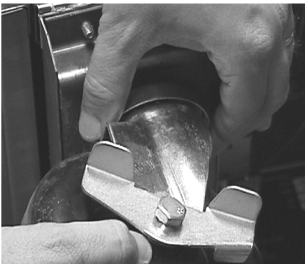
Instalación de la ruedecilla en el conjunto de soporte del pie
