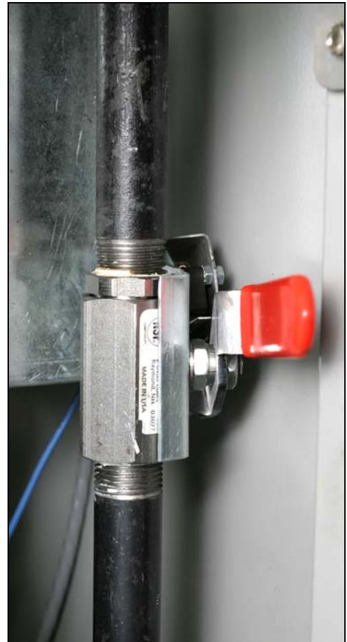
La poignée de soupape de décharge d'huile est montrée dans la POSITION DE REPOS. Abaissez-la pour décharger l'huile de la casserole de filtre.
