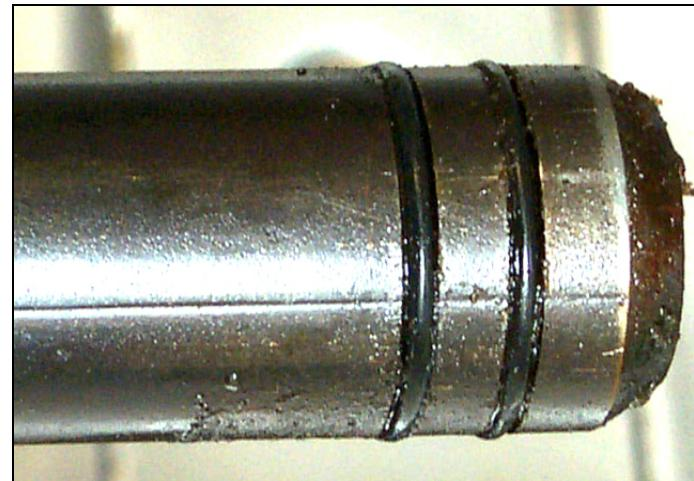
Inspectez les joints toriques du raccord du filtre.
