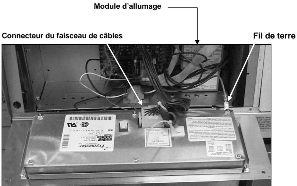
2. Débranchez le faisceau de câbles de l'arrière du contrôleur et, si vous remplacez le faisceau, débranchez-le de la carte d'interface.
