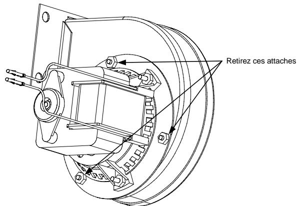
3. Enveloppez le moteur d'un emballage plastique pour empêcher l'eau d'y pénétrer. Vaporisez du produit dégraissant ou du détergent sur la roue et le boîtier de la soufflerie. Laissez agir pendant cinq minutes. Rincez la roue et le boîtier à l'eau chaude du robinet, puis essuyez avec un chiffon propre.
