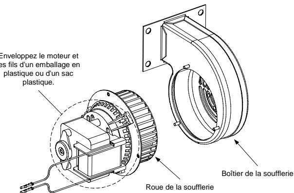
4. Retirez l'emballage plastique du moteur de la soufflerie. Remontez le moteur et le boîtier de la soufflerie. Réinstallez le tout dans la friteuse.
