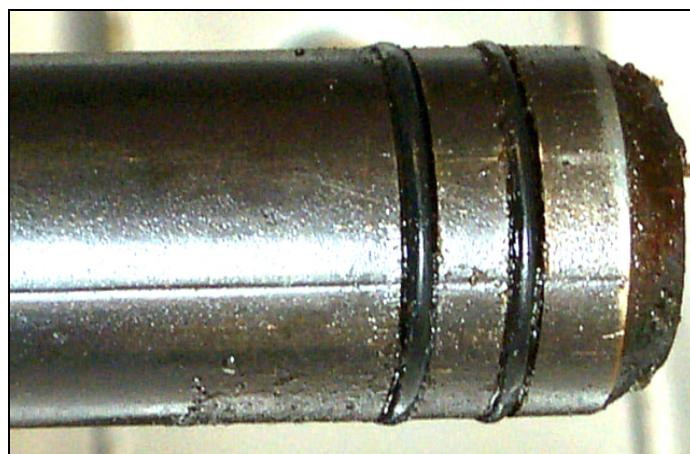
Inspectez les joints toriques du raccord du filtre.
