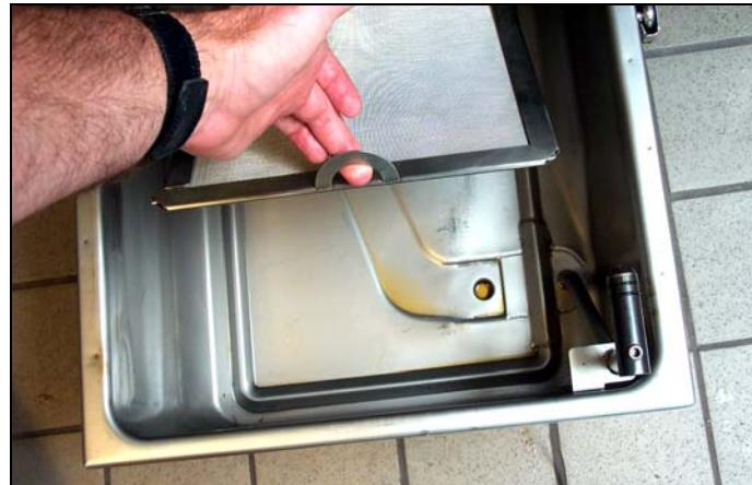
**Remettez l'ensemble du filtre dans le bac, en vous assurant que le raccord situé en bas soit solidement calé dans l'orifice au fond du bac. Saupoudrez uniformément une tasse de poudre à filtre Magnasol XL sur le filtre.**
