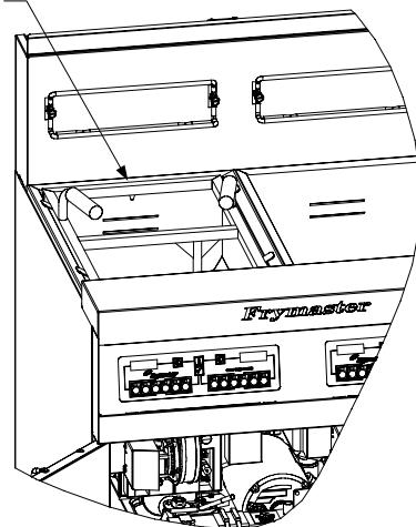
2. Installez la Power Shower. **REMARQUE :** Assurez-vous que le joint torique et le joint d'étanchéité de la Power Shower soient présents et en bon état, et que les vis de nettoyage soient installées à chaque angle.
