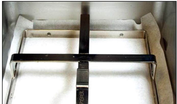
**Si vous utilisez le papier-filtre, placez l'anneau de maintien sur le papier-filtre et abaissez l'anneau dans le bac pour permettre au papier de se replier autour de l'anneau lorsqu'il est poussé au fond du bac. Une fois l'anneau de maintien en position, saupoudrez une tasse de poudre à filtre uniformément sur le papier.**
