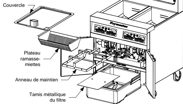
Retirez le plateau ramasse-miettes, l'anneau de maintien et le tamis métallique du bac. Nettoyez tous les composants avec une solution de détergent et d'eau chaude, puis essuyez bien.
