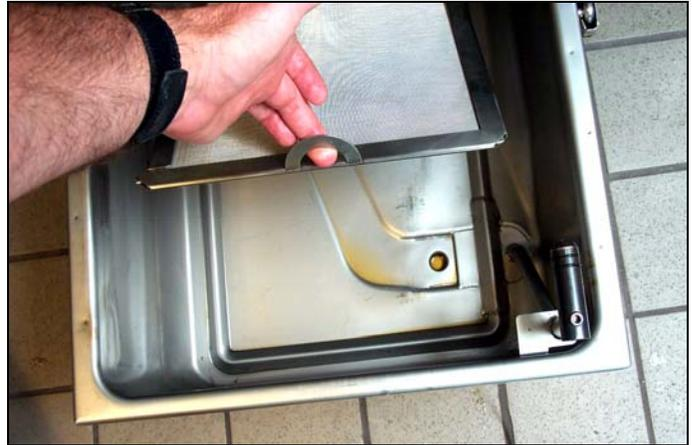
**Retire el ensamblaje de la bandeja de migas y filtro de la fuente. Limpie todos los componentes con una solución de detergente y agua caliente, luego séquelos totalmente.**
