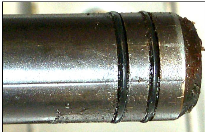
**Inspeccione las juntas tóricas del accesorio de conexión del filtro.**
