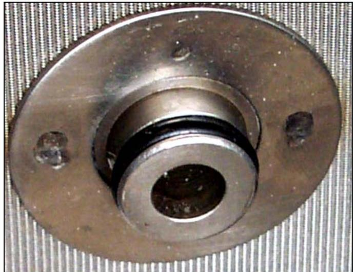
**Inspeccione la junta tórica de la malla del filtro.**
