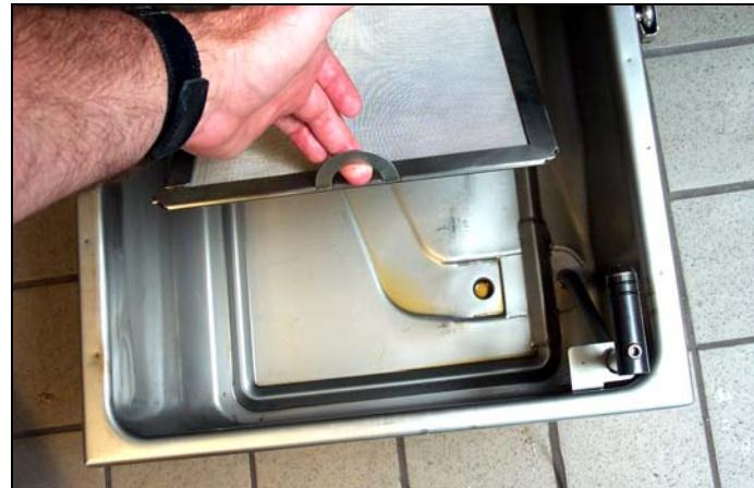
Remettez l'ensemble du filtre dans le bac, en vous assurant que le raccord situé en bas est solidement calé dans l'orifice au fond du bac. Saupoudrez uniformément une tasse de poudre à filtre Magnasol XL sur le filtre.
