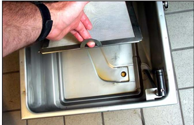
**Retirez le plateau ramasse-miettes et le filtre métallique du bac. Nettoyez tous les composants avec une solution de détergent et d'eau chaude, puis essuyez bien.**
