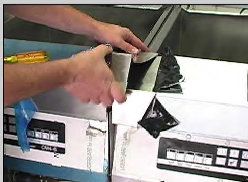
**Figura 6:** Fixe a tira que une as seções da fritadeira. Instale os parafusos sob a borda inferior.
