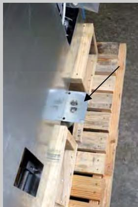
**Figura 2:** Uma centralizado rodízio e seus estendido placa de montagem é mostrado à esquerda. O outro seção do fritadeira é levantada e seguro com parafusos fornecidos.
