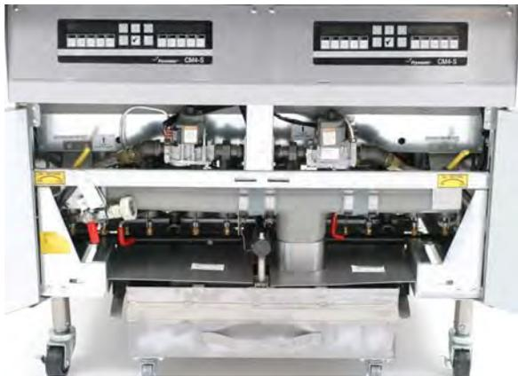
A bandeja do filtro desliza sob a fritadeira (esquerda), conectando-se com um conector macho (direita). Certifique-se de que o tubo coletor esteja firmemente acoplado a este conector. Sua localização pode variar de acordo com o modelo.
