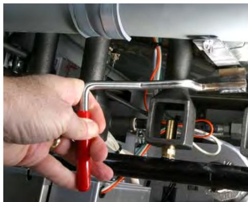
Movendo a alça vermelha da válvula de drenagem para abrir a válvula de drenagem, permitindo que o óleo quente seja drenado para a bandeja do filtro.
