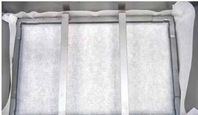
Anel de retenção posicionado corretamente sobre o papel de filtro na bandeja do filtro.
