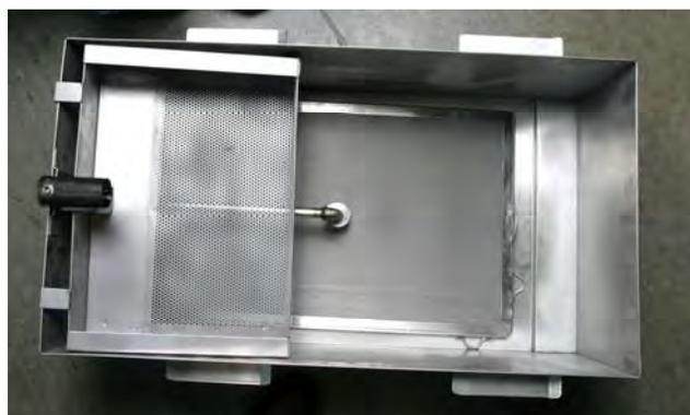
Remova a tela de migalhas levantando-a e retirando-a.
