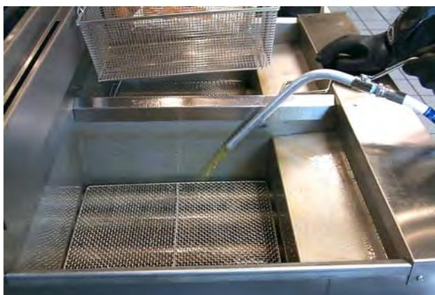
Use a varinha opcional para enxaguar os detritos da cuba para a bandeja do filtro. Mantenha um aperto firme no cabo da varinha em todos os momentos.
