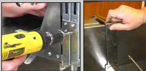
**Figuras 7,8:** Use parafusos para prender os ts de fixação. colchete. Certifique-se de que os parafusos do suporte através traseiro vão para o canal de reforço vertical. Prenda a grife a tira de junção da tampa na parte de trás do cuba de fritura.
