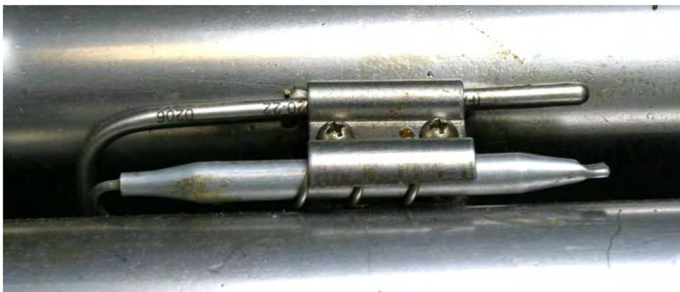
Locais típicos de sonda de limite alto/sensor e hardware de montagem.
