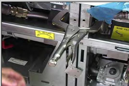
**Figura 5:** Prenda as fritadeiras para facilitar a montagem dos suportes de fixação.
