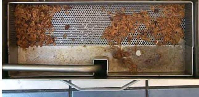
Vazio t ele filtra a bandeja de migalhas em uma bandeja à prova de fogo recipiente no final das operações de fritura de cada dia. NÃO PERMITA QUE MIGALHAS SE ACUMULE NA BANDEJA.
