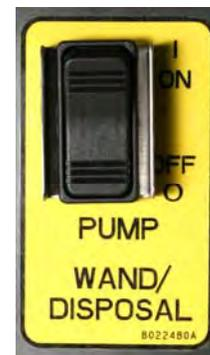
Abra o varinha/descarte válvula (esquerda). Usar o interruptor de balancim (acima) para enviar óleo pela mangueira.
