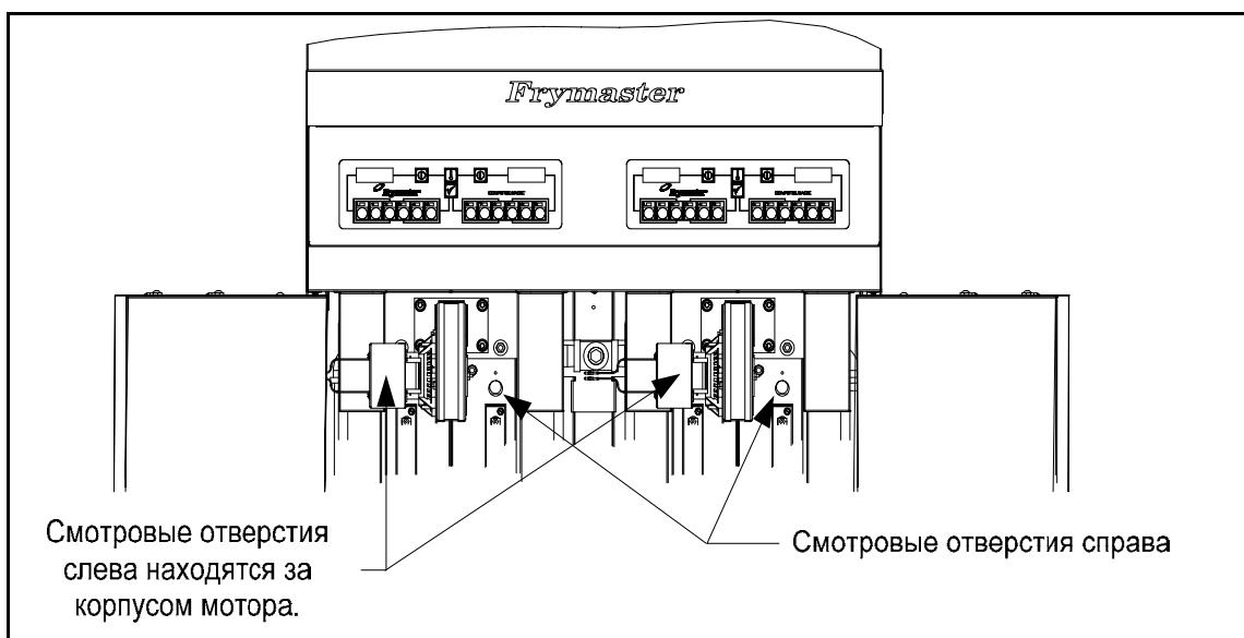
Оптимальный цвет пламени – ярко-оранжевый/красный. Если пламя синее или если на поверхности нагревателя видны темные пятна, измените пропорцию газ-воздух следующим образом: Сбоку кожуха вентилятора напротив мотора находится пластина с крепежной гайкой. Слегка открутите гайку и
