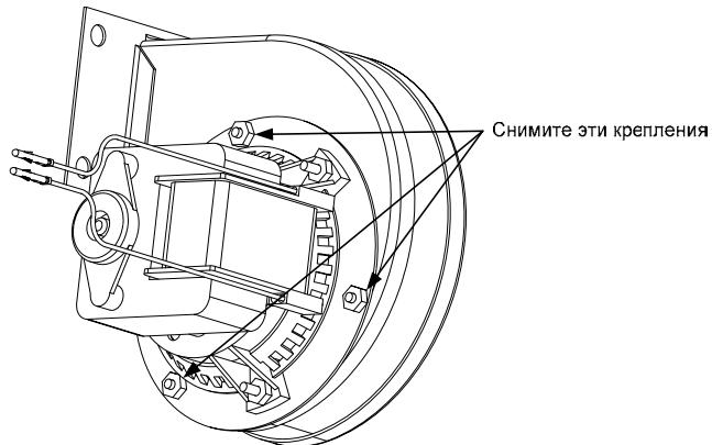
3. Заверните мотор в полиэтиленовую пленку, чтобы в него не попала вода. Спрысните обезжириватель на колесо вентилятора и его корпус. Обезжириватель должен впитаться в течение 5 минут. Сполосните колесо и корпус горячей водой из-под крана и просушите чистой тканью.
