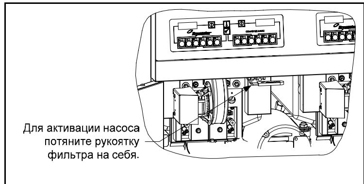
4. В течение 5 минут насос фильтра прокачивает масло через фильтр и прогоняет его через обжарочную ванну. Этот процесс называется полировкой. Полировка очищает масло за счет отфильтровки твердых частиц.
