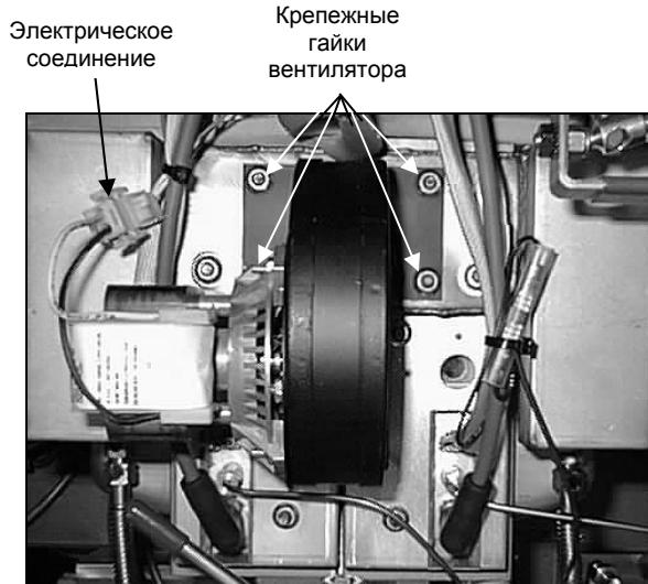
2. Снимите три крепления, при помощи которых мотор вентилятора крепится к корпусу вентилятора, и извлеките мотор из корпуса.
