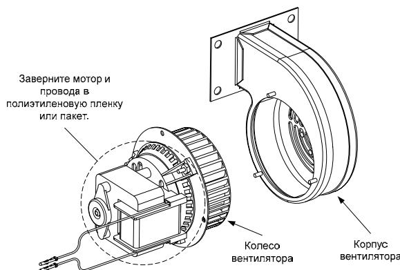
4. Снимите полиэтиленовую пленку с мотора вентилятора. Вставьте мотор в корпус. Установите вентилятор во фритюрницу.
