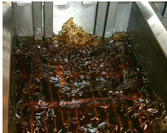
**5** Das in die Frittierwanne zurückgeführte Fett 10-15 blubbern lassen; dadurch wird das Fett aus den Rücklaufleitungen gedrückt.
