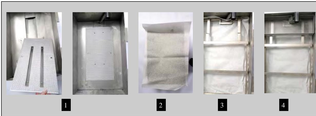
1. Inneres Sieb — sicherstellen, dass es auf Stifte und Abflachungen ausgerichtet ist.
