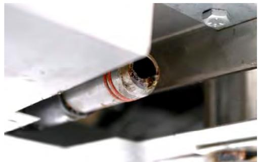
5. Sicherstellen, dass die O-Ringe am Aufnahmerohr intakt sind.
