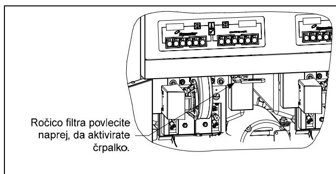
4. Filtrirna črpalka izčrpa olje za cvrtje skozi filter in ga vrne v bazen v 5-minutnem postopku filtriranja. Filtriranje očisti olje z odstranjevanjem trdnih delcev.
