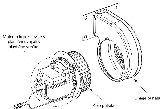
4. Odstranite plastični ovoj z motornega sklopa puhala. Sestavite motorni sklop in ohišje puhala. Puhalo namestite nazaj v cvrnik.
