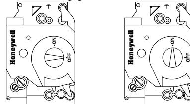
2. Stikalo ON/OFF (VKLOP/IZKLOP) računalnika/krmilnika preklopite v položaj ON (VKLOP) in termostat ali program računalnika nastavite na običajno temperaturo za kuhanje.
