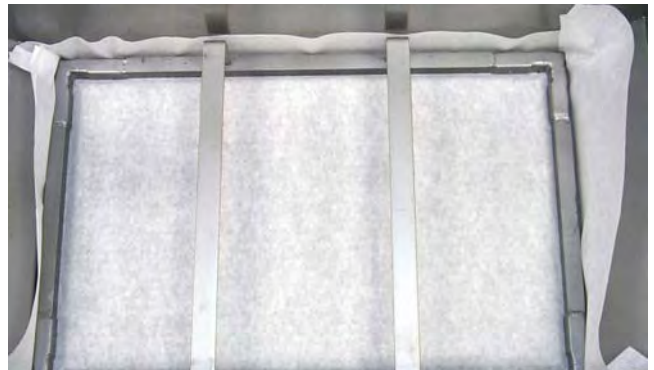
Korrekt auf dem Filterpapier in der Filterwanne angebrachter Niederhalter.
