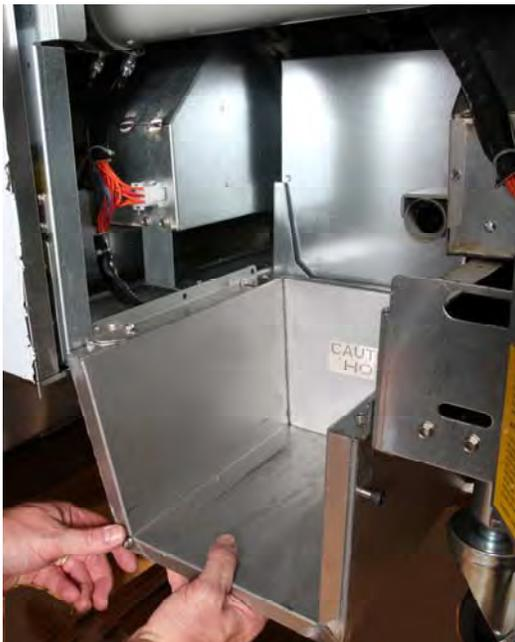
**Εικόνα 2:** Τοποθετήστε το melter.
