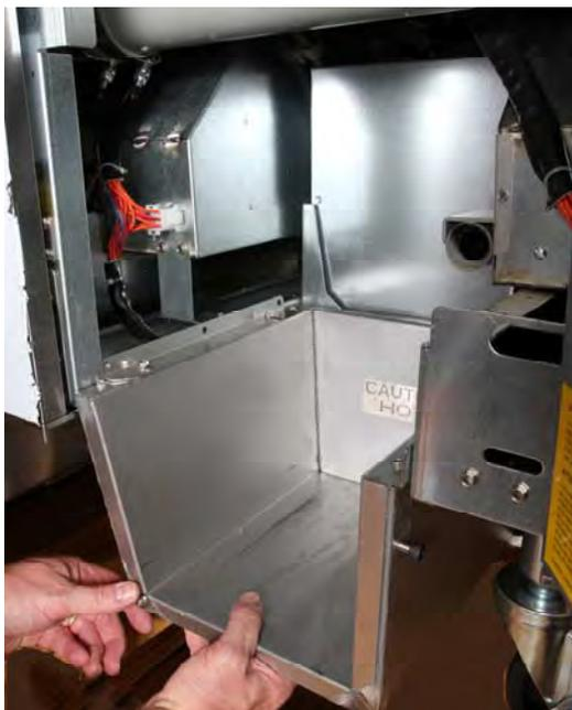
**Abbildung 2:** Das Schmelzgerät platzieren.
