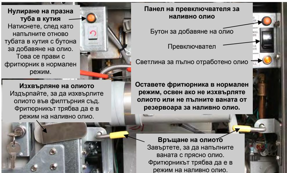
**ЗАБЕЛЕЖКА:** Външният вид на фритюрника ви може да се различава леко от показаното, в зависимост от конфигурацията, типа на фритюрника и датата на производство.
