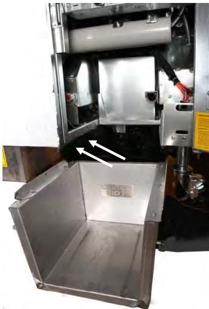
Рис. 1. расположите устройство для растапливания в шкафу, прикрепив входящими в комплект поставки винтами к внутренним компонентам.
