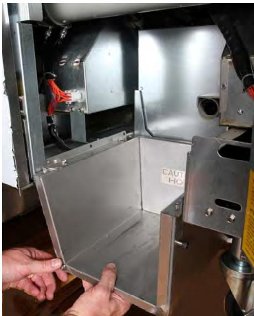
Рис. 2. Установите устройство для растапливания.
