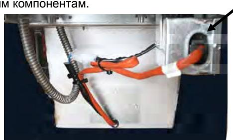
Рис. 3. Вставьте черный соединитель во вспомогательный разъем, см. рисунок. Отдельный пучок проводов с белым штекером, при наличии такого, **НЕ** должен использоваться.
