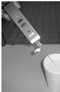
**水にプローブを挿す** 氷水にプローブを挿し、測定温度が安定するまでかき混ぜます。
