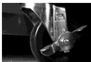
フライヤーの脚にキャッピング部品が付いている場合は、キャッピング部品の前面を持ち上げてバックブラッシュをフィルターシェルフから外します。キャッピング部品がフィルターシェルフから外れるまで、フライヤーを注意して動かして防火壁から離します。
