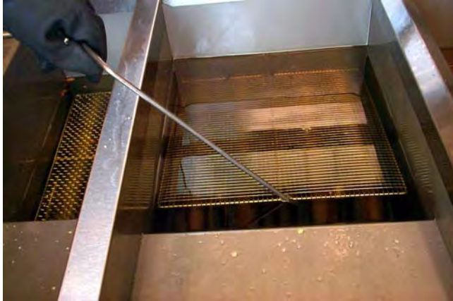
قم باستبدال شبكة المقلاة, وتجنب تناثر الزيت الساخن.
