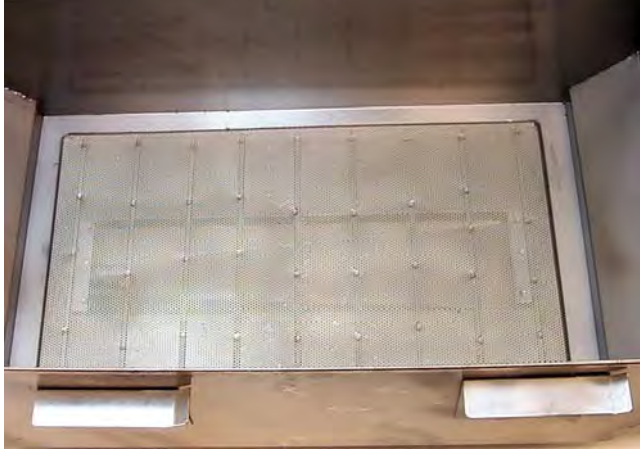
شبكة الدعم المثبتة داخل وعاء التصفية بصورة ملائمة.
