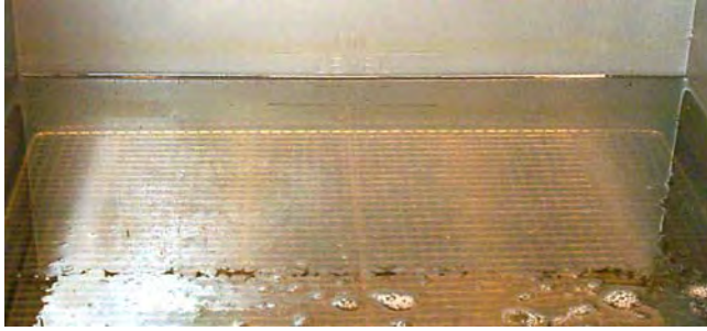
أضف الزيت/السمن حتى يصل المستوى إلى أعلى نقطة في خط مستوى الزيت, وتجنب ملئ المقلاة بصورة مفرطة.
