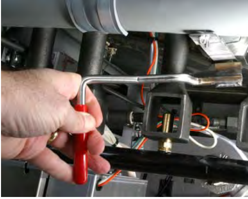
حرك مقبض صمام التصريف الأحمر لفتح صمام التصريف، حيث يؤدي ذلك إلى تصريف الزيت الساخن داخل وعاء المصفاة.
