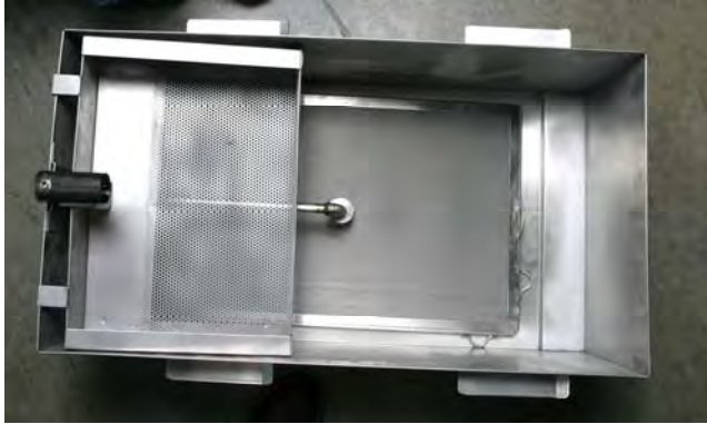
مصفاة الفتات مُثبتة داخل وعاء التصفية بصورة ملائمة.
