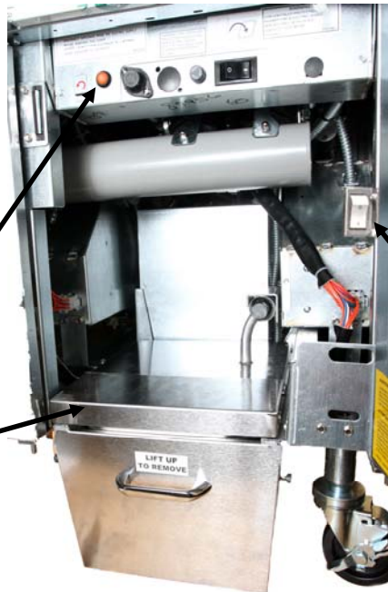
يعمل الزر البرتقالي على إعادة ضبط النظام بعد ظهور علامة انخفاض مستوي الزيت.
