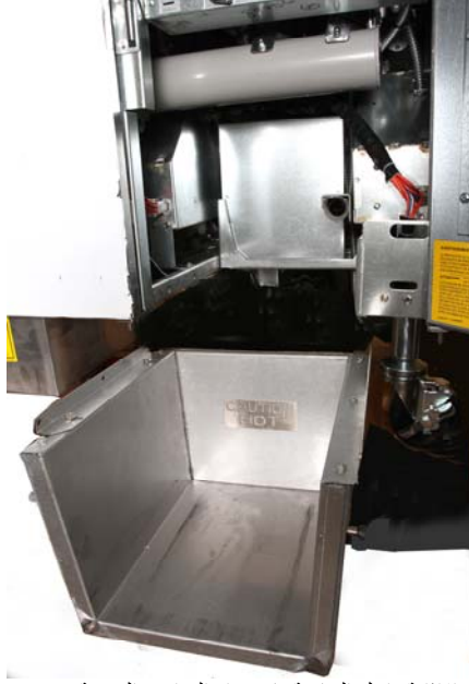
الشكل 1: ثبت وحدة الإذابة داخل الحاوية باستخدام البراغي المرفقة.
