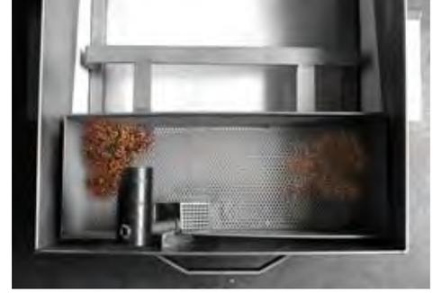
Filtreleme işlemi tamamlandıktan hemen sonra kırıntı ızgarasının içindeki maddeleri yanmaz bir kabın içine boşaltın.
