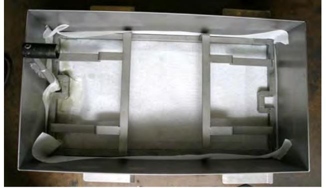
10. 1 fincan (227 gram) filtre tozunu kağıdın üzerine eşit olarak serpiştirin. Filtre tozunu filtre kağıdının üzerinde eşit olarak dağıtmak için bir ölçü fincanını ya da kepçesini kullanın.
