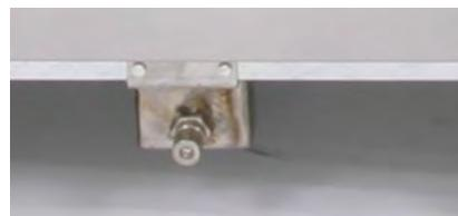
Подключите утилизационный шланг с направляющей насадкой к быстроразъемному соединению на передней части фритюрницы.
