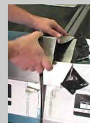
Для перекрытия зазоров между обжарочными ваннами и верхними крышками сборные полосы.
