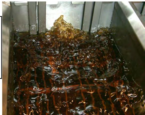
**6** Насос должен продолжать функционировать в течение 10-15 секунд после появления пузырьков в обжарочной емкости с целью удаления всего масла из возвратных трубопроводов.
