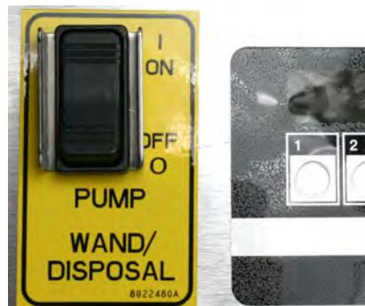
Направьте шланг в обжарочную емкость и включите насос тумблером на передней части фритюрницы.
