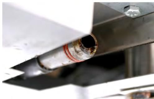
5. Убедитесь в хорошем состоянии уплотнительного кольца на охватываемом конце заборной трубы.
