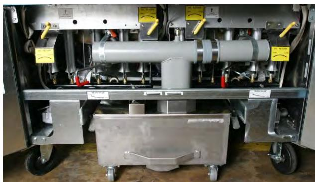
Рычаги в правой и левой частях шкафа предназначены для возврата масла через задние патрубки обжарочной емкости. Рычаги в центральной части шкафа предназначены для возврата масла через верхний раstrub. В любом случае, желтый рычаг используется для возврата масла в расположенную непосредственно сверху обжарочную емкость.
