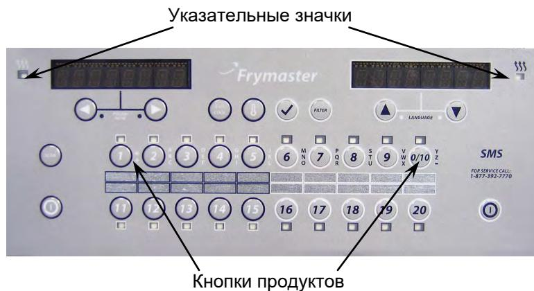
После повышения температуры до 38°C фритюрница переходит в режим непрерывного нагрева. До достижения заданного значения на дисплее контроллера будет показываться действительная температура масла. После нагрева фритюрницы до уставки на контроллере появится сообщение drop («Опустить продукт»).
