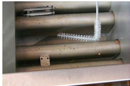
Используйте тефлоновый ершик Г-образной формы для разрыхления загрязнений в ходе слива масла из обжарочной емкости.
