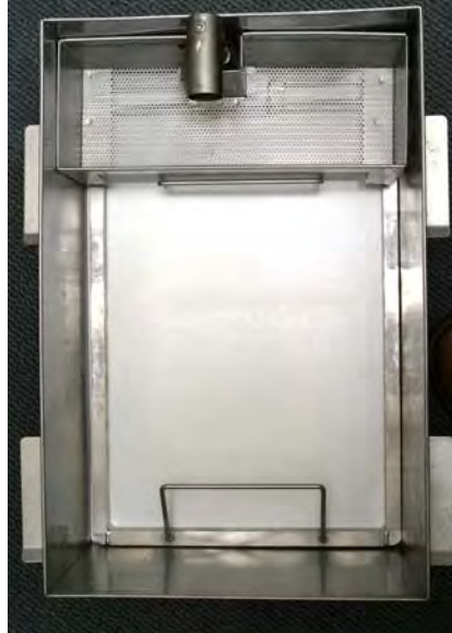
وعاء التصفية مع الوسادة وحلقة التثبيت وصينية البقايا في موضعها.
