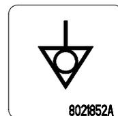
Dank der potenzialausgleichenden Massenöse können alle Vorrichtungen desselben Orts elektrisch verbunden werden, um sicherzustellen, dass keine elektrischen Potentialdifferenzen zwischen Geräten bestehen, die gefährlich sein könnten.
