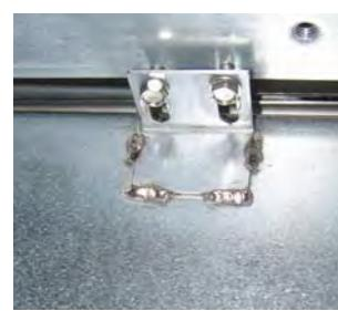
**Obrázek 5:** Upevněte rozpouštěč ke kolejnicím na obou stranách.
