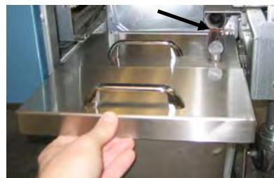
**Obrázek 4:** Položte víko na nádobu a zasuňte spojku sací trubky oleje do protikusu.
