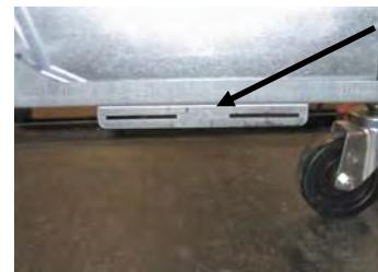
**Obrázek 1:** Upevněte montážní držák k dolní straně vzpěry skříně ATO.
