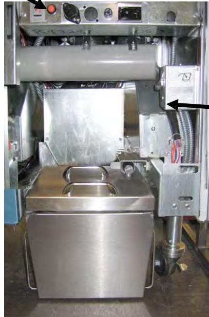
Napájecí spínač rozpouštěče
