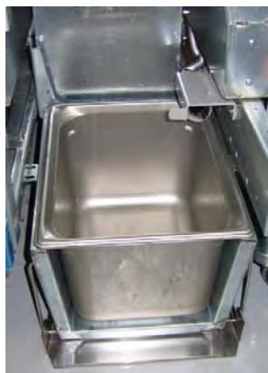
**Obrázek 3:** Vložte vnitřní zásobní nádobu oleje do rozpouštěče.
