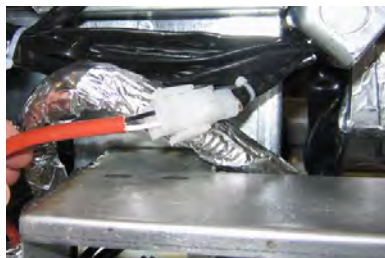
Фигура 6: Прикрепете двуцифтовите бели конектори и включете черния конектор в помощната кутия, както е показано. * Имайте предвид, че позицията на черната връзка може да се различава от снимката.
