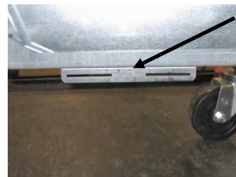
Фигура 1: Прикрепете скобата за подравняване към долната част на скобата на кутията АТО.
