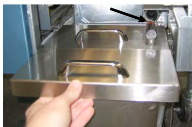
Фигура 4: Поставете капака върху тигана и плъзнете тръбата за поемане на масло в женския смукателен съд.
