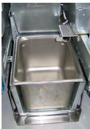
Фигура 3: Поставете вътрешния съд на резервоара за масло в уреда за топене.
