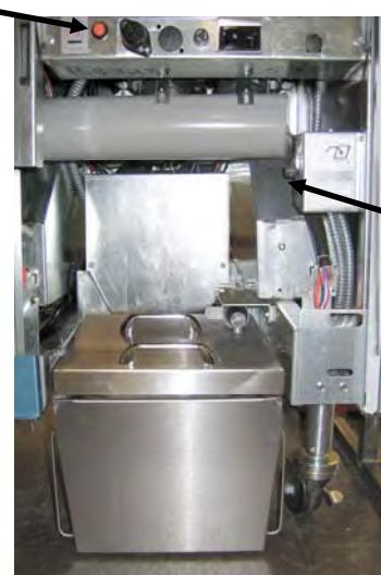
Рис. 7. Собранные устройства для растапливания жира установлены в требуемом месте.
