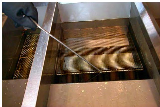
Vor dem Filtrieren das Traggitter aus dem Frittierbehälter entfernen.
