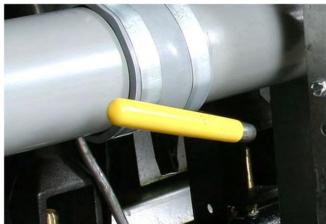
Das gefilterte Öl wieder in die Frittierwanne füllen, indem das Ölrücklaufventil durch Ziehen am gelben Griff geöffnet wird.
