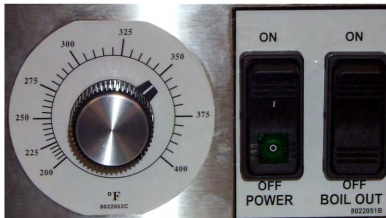
Elektronischer Thermostatregler mit Netzschalter und Auskoochoption.
