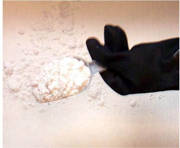
Korrekte Menge an Filterpulver gleichmäßig auf das Papier streuen.
