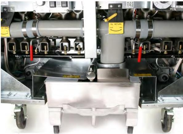
Typischer Unter-Frittiermaschinen-Filter (UFF) in einem Frittiersystem mit Mehrfachwannen.
