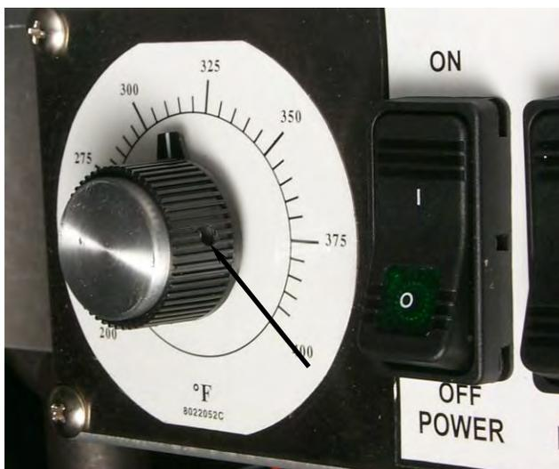
Stellschraube des Drehschalters (Pfeil – im Schalter eingesetzt)
