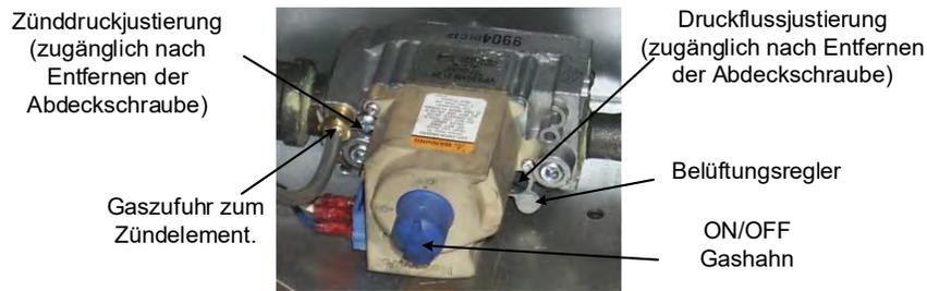
Typisches Nicht-CE-Gasventil für Frittiermaschinen, die mit elektronischer Zündung ausgestattet sind.
