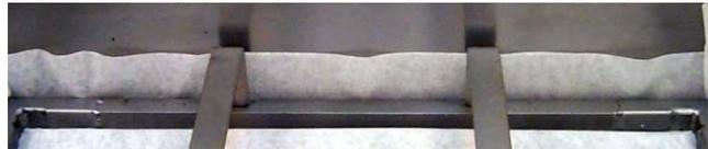
Sicherstellen, dass das Filterpapier an allen Seiten um ca. 5 cm nach oben übersteht und dass es gleichmäßig unter dem Niederhaltering angebracht ist.
