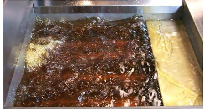
Öl 10 bis 15 Sekunden lang sprudeln lassen, um sicherzustellen, dass das gesamte Öl aus den Rückleitungen entfernt wurde.
