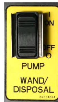
Nach korrekter Positionierung des Stabs innerhalb der jeweiligen Frittierwanne, die Filterpumpe über den Stab/Entsorgungsschalter an der Frittiermaschine aktivieren.
