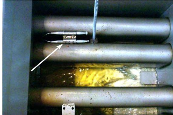
Während des Ölumlaufts alle Rückstände und schwebenden Teilchen von den Brennröhren und aus der Frittierwanne entfernen. Vorsichtig arbeiten, damit die Sonden (Pfeile) auf den Brennröhren nicht beschädigt werden.
