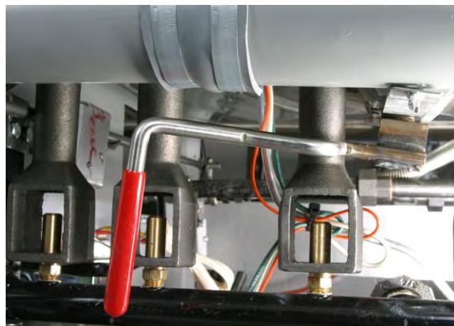
Nach Beendigung des Filterens muss der rote Griff des Ablassventils geschlossen werden, um die Filterwanne wieder zu füllen-
