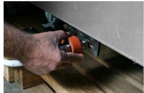
Optionaler Schlauch/Stab-Verbinder, der korrekt an der Schnellkupplung des Frittiermaschinenschrankes angeschlossen
