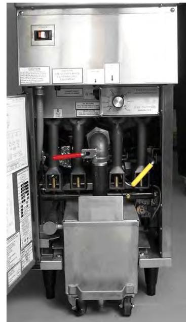
Typischer Einzel-Unter-Frittiermaschinen-Filter (SUFF) in einem Frittiersystem mit Einzelwanne.
