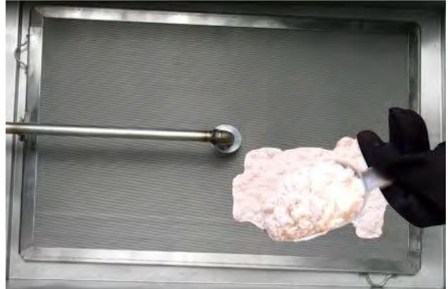
Filterpulver auf das Filterblatt auftragen.
