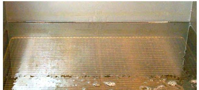
Solange Öl/Frittierfett nachfüllen, bis es die obere ÖLFÜLLSTANDSLINIE erreicht. **DIE FRITTIERWANNE NICHT ÜBERFÜLLEN.**
