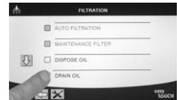
**4 Die Taste JA (✓) drücken.** Auf der Steuerung erscheint DRAIN OIL TO PAN? (FETT IN WANNE ABLASSEN?).
