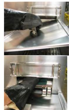
Nachdem die Fläche gereinigt wurde, Rückstände mit einem in Hygienelösung angefeuchteten Tuch abwischen. **Sicherstellen**, dass in der Umgebung von heißem Fett **keine Lösung vom Tuch tropft**.
