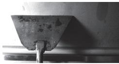
Sur une friteuse électrique, utiliser ensuite le couteau à mastic pour gratter toute la graisse molle et le carbone dur de toute la tôle autour de la friteuse, de la pièce d'espacement et du support de la friteuse. Après avoir nettoyé ces zones, passer directement à l'étape 8.
