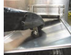
Appliquer une petite quantité de nettoyant pour friteuse QSR sur un tampon à récurer haute température ou anti-rayures (électrique uniquement).
