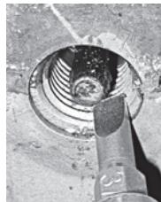
Nettoyer les sédiments autour des sondes AIF et ATO (toutes les friteuses). Utiliser un tournevis ou un objet similaire pour accéder aux contours de la sonde. Faire attention de ne pas endommager la sonde.
