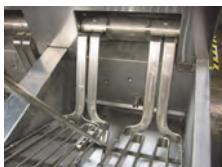
Remplacer les couvercles de friture et essuyer l'excédent d'huile des éléments à l'aide d'un essuie-tout.
