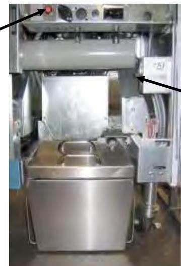
**Abbildung 7:** Die montierte Schmelzeinheit in ihrer Position.
