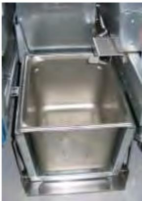
**Abbildung 3:** Die innere Fettbehälterwanne in die Schmelzeinheit einsetzen.
