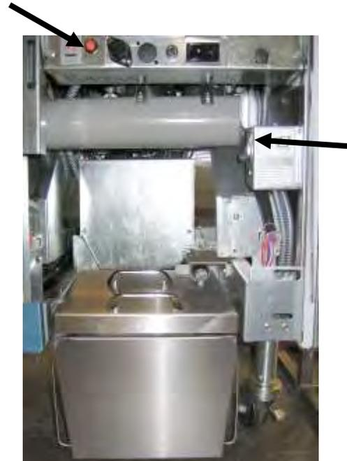
Netzschalter der Schmelzeinheit
